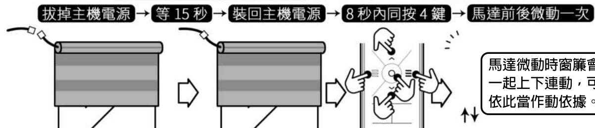
**STEP-2** 馬達震動一次後，8秒內同時按遙控器的開+關鍵，馬達微動一次，表示已完成清除。
